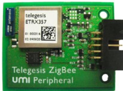
UMI-ZigBee-Kommunikationsmodul von Telegesis
