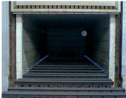
Bild 6: Herdwagenofen mit BIC Hochgeschwindigkeitsbrennern Fig. 6: Bogie hearth furnace with BIC high-speed burners
