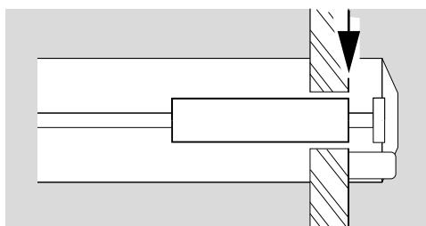
→ Απόσταση του ηλεκτροδίου ανάφλεξης από τον πείρο γείωσης ή από το ακροφύστιο αερίου:  $2 \pm 0,5 \text{ mm} (0,08 \pm 0,02 \text{ inch})$ .
