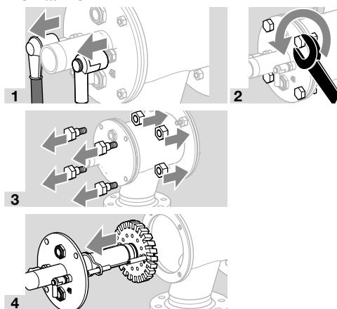
→ Αφού αποσυναρμολογηθεί το ένθετο καυστήρα, πρέπει να αντικατασταθεί το παρέμβυσμα φλάντζας σύνδεσης με καινούργια.
