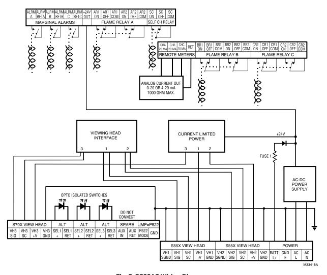
Fig. 5. P532AC Wiring Diagram.
