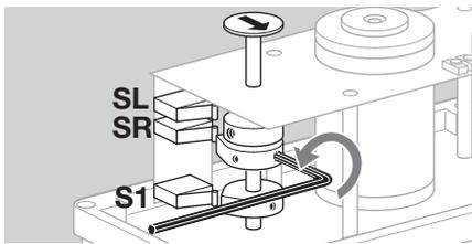
▷ Jetzt ist die Schaltnocke drehbar.
