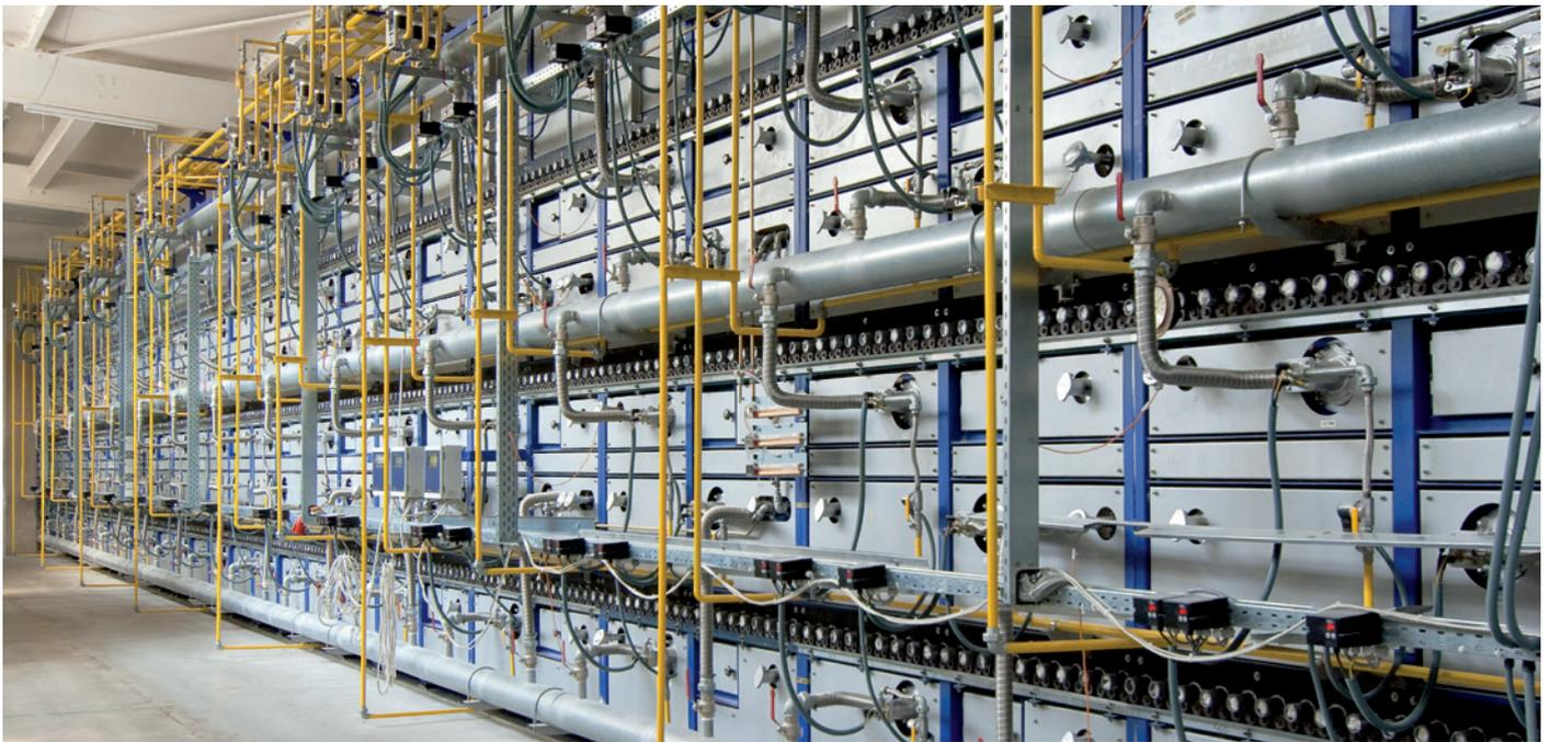
Roller hearth kiln, works photograph Keramischer OFENBAU GmbH
