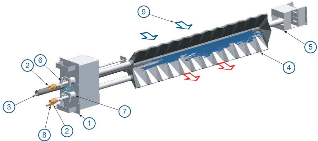
Alle "HC" AIRFLO® Brenner schließen eine Montagekassette aus Edelstahl ein, die nicht nur den Brenner lagert, sondern auch die Zündbrenner und Zubehör, wie Zündtransformatoren, UV-Zellen usw. trägt. Eine Befestigung aus Edelstahl, die das Gewicht des Brenners abstützt, ist serienmäßig vorgesehen. Damit wird der Brenner als Komplettpaket geliefert und ermöglicht einfache Installation vor Ort.
