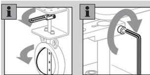
**9** Voltar a fechar a válvula borboleta. Observar a marcação da posição do disco da válvula borboleta!
