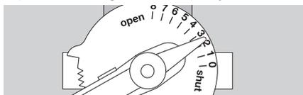
O puxador de engate está num ângulo de 90° transversalmente à tubulação = válvula fechada (shut).
