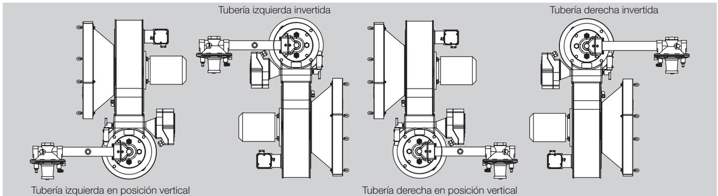
A pesar de que el motor del soplador está en el lado “izquierdo” de las unidades invertidas, sigue siendo un motor “derecho” en relación con el conjunto del soplador.
