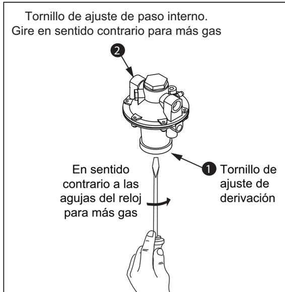
**Figura 4.16 Regulador de proporción con tornillo de ajuste de paso interno**
