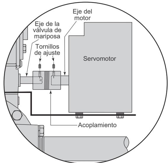
Figura 3.10. Montaje del servomotor
