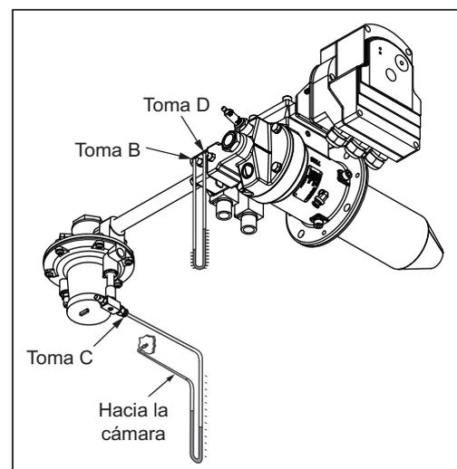
**Figura 4.17 Comprobación de la configuración**
