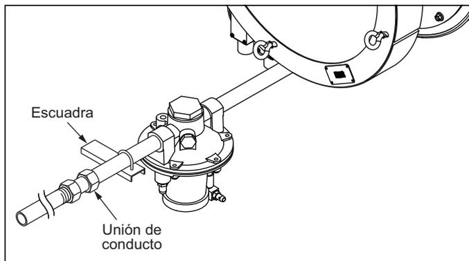
Figura 3.9. Conexiones de las tuberías
