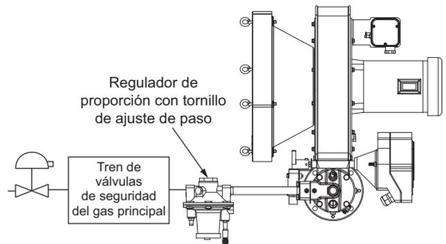
**NOTA:** El quemador RatioAir con opción de ratio alta incluye un regulador de proporción con ajuste de paso interno.
