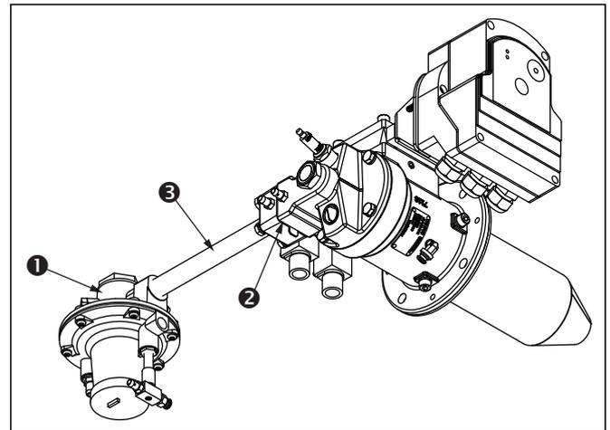
Figura 3.7. Tuberías del quemador
