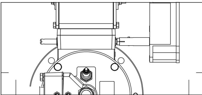
**Figura 4.4 Actuador con acoplamiento con pasador**
