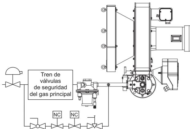
Gas de arranque de paso **con** medidor de orificio de combustible
