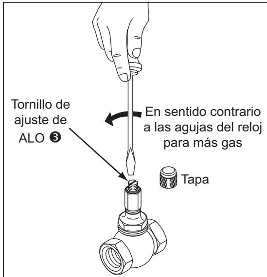
**Figura 4.12 Orificio limitador ajustable (ALO)**
