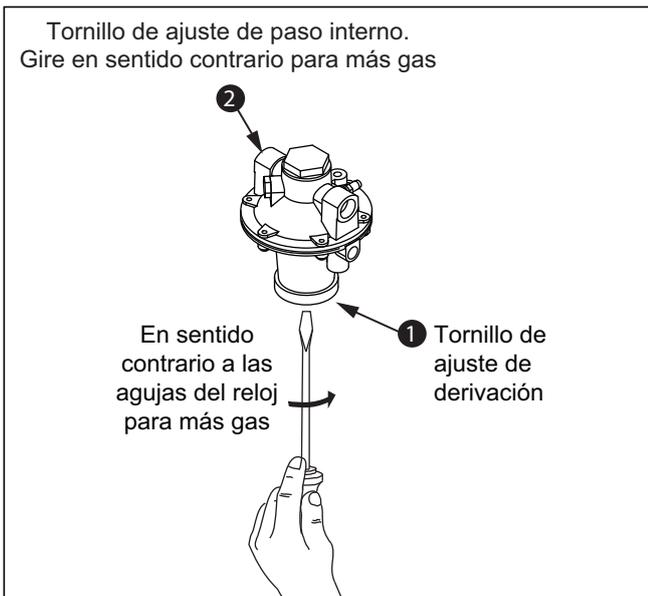
**Figura 4.10 Regulador de proporción con tornillo de ajuste de paso interno**
