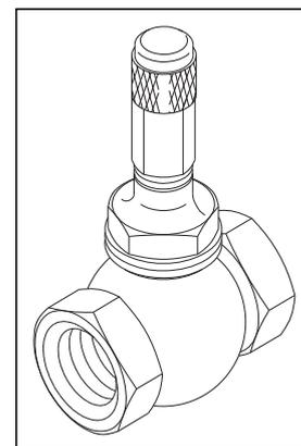
**Figura 4.14 Orificio limitador ajustable (ALO)**
