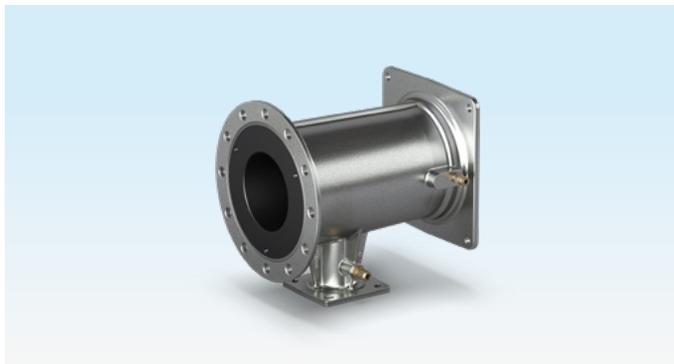
L'unité de mélange venturi permet la régulation modulante d'un brûleur à prémélange avec un rapport gaz/air constant jusqu'à 14 à 17% de la charge maximale.
