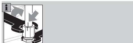
▷ Při opakované montáži bude přesuvná matice utažena do původní polohy a pak dotažená o dalších cca  $30^\circ$ .
