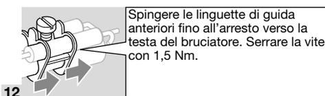
Spingere le linguette di guida anteriori fino all'arresto verso la testa del bruciatore. Serrare la vite con 1,5 Nm.
