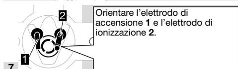
Orientare l'elettrodo di accensione 1 e l'elettrodo di ionizzazione 2.
