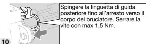
Spingere la linguetta di guida posteriore fino all'arresto verso il corpo del bruciatore. Serrare la vite con max 1,5 Nm.
