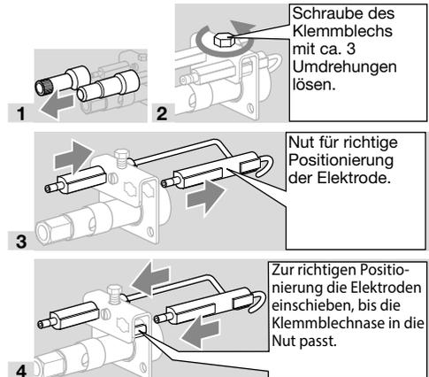
Schraube des Klemmblechs mit ca. 3 Umdrehungen lösen.
