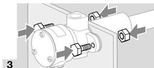
4 Zündgasleitung mit Rp ¼ und Luftleitung mit Rp ½ anschließen.
