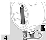
→ PG-Verschraubung **P** festschrauben.
