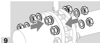
→ Lavare accuratamente le tubazioni dopo il montaggio per rimuovere corpi estranei nel sistema.
