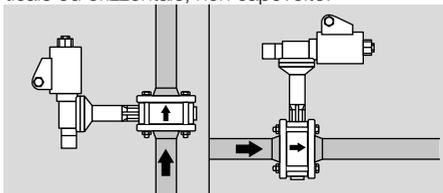
→ Con una posizione di montaggio verticale con direzione di flusso dal basso verso l'alto si evitano la raccolta di condensa e sporcizia sulla battuta di arresto della valvola a farfalla.
