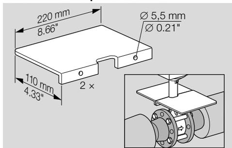
L'attuatore elettromagnetico si può utilizzare unitamente alla valvola a farfalla BVHM per aria calda: fino a 250 °C (480 °F), fino a 450 °C (840 °F) se si montano delle lamiere dissipatrici.
