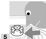
→ L'attuatore elettromagnetico con anello di giunzione viene inserito leggermente spostato (ca. 10°) nel trascinatore della valvola a farfalla.
