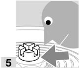
→ Der Magnetantrieb mit Kupplungsring wird leicht versetzt (ca. 10°) in den Mitnehmer der Drosselklappe eingesetzt.
