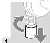
→ Um  $Q_{\max.}$  einzustellen, muss Spannung am Magnetantrieb anliegen. Stromlos ist die Drosselklappe geschlossen.
