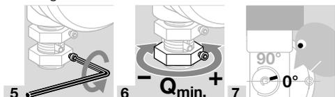
8 Nach erfolgreicher Einstellung beide Einstellschrauben für  $Q_{\min.}$  und  $Q_{\max.}$  wieder festschrauben.
