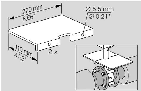
Magnetaktuatoren brukes i forbindelse med spjeldventilen BVHM for varmluft: inntil 250 °C (480 °F), inntil 450 °C (840 °F) med varmeavledningsplater. Ved isolert rørløsning må det sørges for ledig plass til montering av varmeavledningsplatene og skrueforbindelsene i området rundt spjeldet. Bestillingsnummer: 74921670
