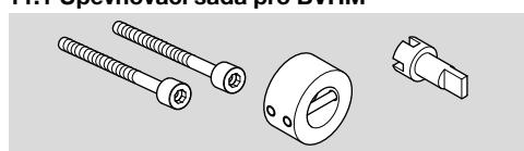
Potřebná k upevnění magnetického pohonu MB 7 na škrťcí klapku BVHM. Upevňovací sada se dodává v přiloženém balíčku.
