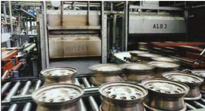
Industrie de l'aluminium : four de durcissement pour les jantes
