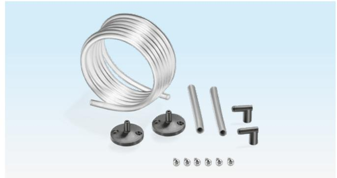
Schlauchset mit 2 m PVC-Schlauch (Ø 4,75 x 1 mm), 2 Kanalanschlussflanschen mit Schrauben, Anschlussnippel R 1/4 und R 1/8.
