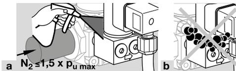
**3** Comprobar la estanquidad de la válvula de bypass / de gas de encendido en la entrada y en la salida.
