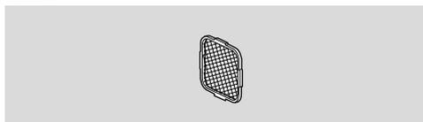
→ Se debe instalar un tamiz en el lado de entrada del dispositivo. Si se instalan dos o más válvulas electromagnéticas para gas seguidas, solo se necesita instalar un tamiz en la primera de ellas, en el lado de entrada.
