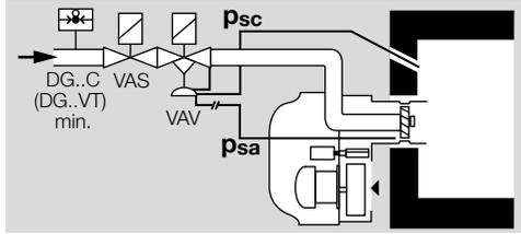
→ VAV..K: 2 uniones roscadas para tubo flexible de plástico ( $\varnothing$  interior 3,9 mm (0,15");  $\varnothing$  exterior 6,1 mm (0,24")) montadas.
