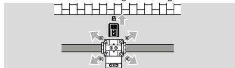
→ Para evitar vibraciones, mantener el volumen reducido entre el regulador y el quemador mediante un tubo corto ( $\leq 0,5\text{ m}$ ,  $\leq 19,7''$ ).
