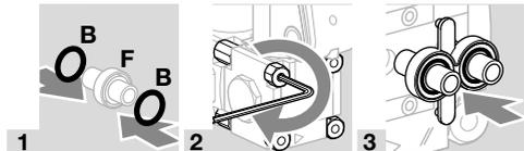
**4** Retirar los tapones de cierre del lado de montaje de la válvula de bypass.
