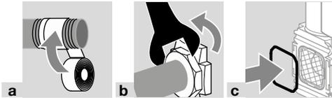
→ Deben estar montados la junta tórica y el tamiz (figura c).
