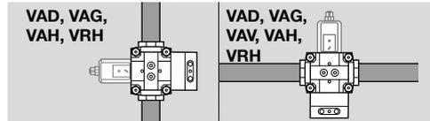
VAD, VAG, VAH: actuador electromagnético negro en posición vertical o en posición horizontal, no cabeza abajo. En caso de ambiente húmedo: actuador electromagnético negro siempre en posición vertical. VAG/VAH/VRH en posición horizontal con regulación por modulación: presión mínima de entrada  $p_{u, \text{mín.}} = 80 \text{ mbar (32 "CA)}$ .
