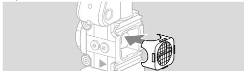
→ Para fijar el diafragma de presión diferencial en la salida del regulador, el marco de sujeción debe estar montado.
