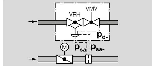
**3** Recomendamos montar una válvula de ajuste de precisión VMV directamente aguas abajo del regulador en la tubería de gas. Ver instrucciones de utilización "Módulo filtro VMF, diafragma de medición VMO, válvula de ajuste de precisión VMV". Las instrucciones están también disponibles en [www.docuthek.com](http://www.docuthek.com).
