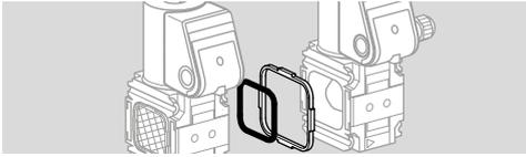
→ Si se montan dos dispositivos (reguladores o válvulas), es necesario montar un marco de sujeción con una doble junta de bloque.
