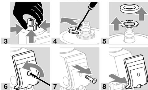
→ Desmontar el pasacables M20 o cualquier otro tipo de conexión.
