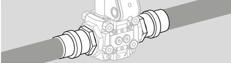
→ Las juntas de algunos accesorios de conexión a presión para gas están homologadas hasta 70 °C (158 °F). Este límite de temperatura se mantiene con un caudal mínimo de 1 m³/h (35,31 SCFH) a través de la tubería y una temperatura ambiente máxima de 50 °C (122 °F).
