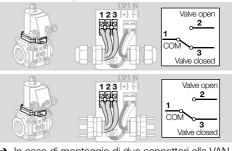
→ In caso di montaggio di due connettori alla VAN con fine corsa: contrassegnare prese e connettori per evitare eventuali scambi.
