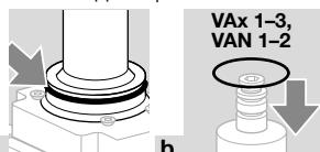
**c****c** Продвните уплотнение под второй паз.
