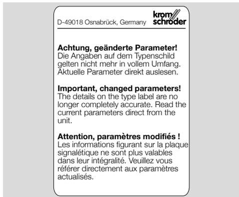
À coller sur le plan de raccordement du PFU 760, 780 après modification des paramètres de l'appareil réglés en usine.
