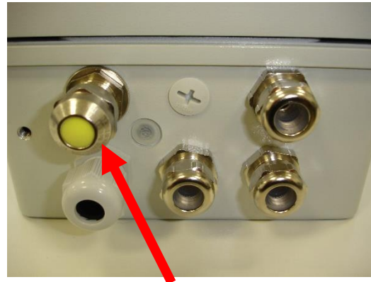
Abb. 14: Spezielle EMV-Kabelverschraubung für die Montage des Ethernetkabels
