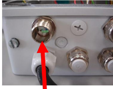
Abb. 16: Einschraubteil der EMV-Kabelverschraubung
