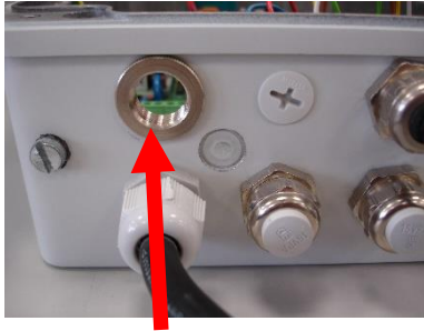
Abb. 15: Reduzierung M20 auf M16
