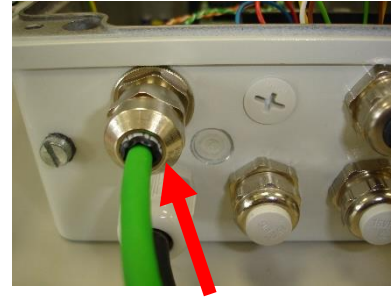
Abb. 17: Fertig montierte EMV-Kabelverschraubung
