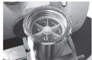
Fig. 6 | Serbatoio di contenimento dell'olio
