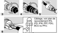
→ Il est également possible de raccorder des conducteurs flexibles sans embouts sur les bornes à ressorts. Pour insérer un conducteur flexible, l'élément de serrage doit être ouvert via le poussoir.
