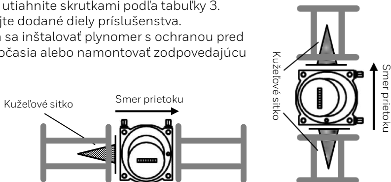
Obr. 11 | Montáž kuželového sitka
