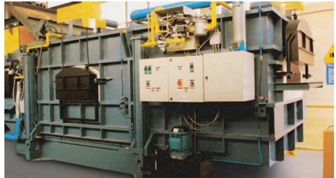
Regulador de proporción en horno de fusión para asegurar una combustión estequiométrica en toda la gama de potencia
