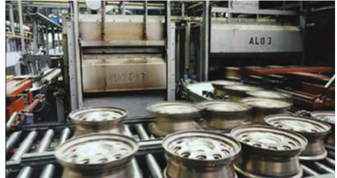
Aluminium-Aushärteofen mit Gleichdruckreglern zur Luftmangelsicherung
