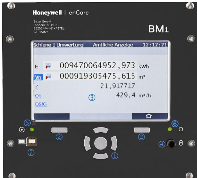
Abb. 3: Beispiel BM1 Vorderseite, exemplarisch für 1/3 Baubreite
