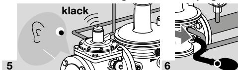
→ JSAV-enheten har lukket på korrekt måte: For å sette anlegget i drift igjen, må JSAV-enheten åpnes igjen, se side 4 (10 Reset).
