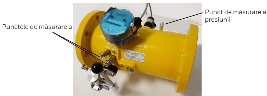
Fig. 4 | Punctele de măsurare a temperaturii și presiunii
