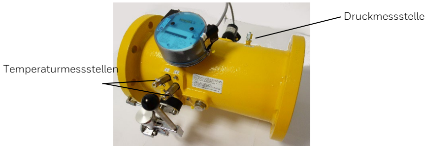
Abb. 4 | Temperatur- und Druckmessstellen
