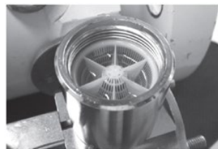
Fig. 5 | Serbatoio di contenimento dell'olio
