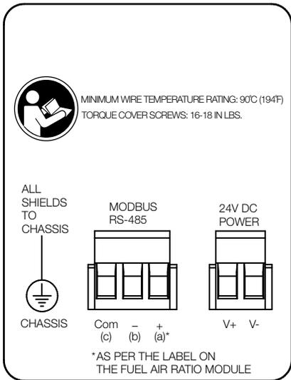
**Fig. 4. Wiring terminals.**
