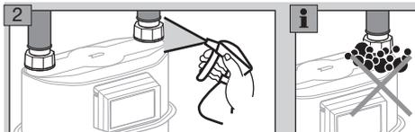
▷ Si el contador de gas de membranas ha sido equipado posteriormente con una línea de medición de presión, comprobar esta conexión.
