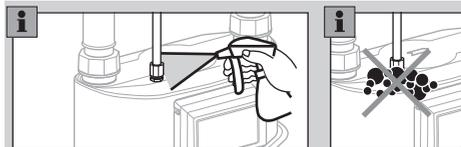
▷ Si en el contador de gas de membranas ha sido abierto e cerrado la toma de presión según BS4161, comprobar la estanquidad de esta conexión.
