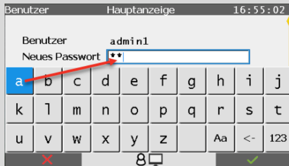
Abb. 9-7: Fernes Bedienfeld aktiv – Taste a wurde gedrückt
