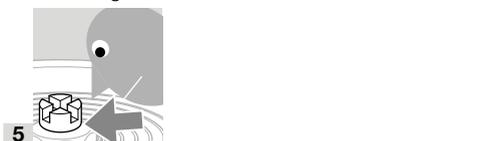
→ Magnetaktuatoren med koplingsring settes inn i medbringeren til spjeldventilen med en liten vinkel (ca. 10°).
