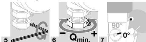
8 Etter at innstillingen er avsluttet, må de to innstillingskrueene for  $Q_{\min.}$  og  $Q_{\max.}$  skrues fast igjen.
