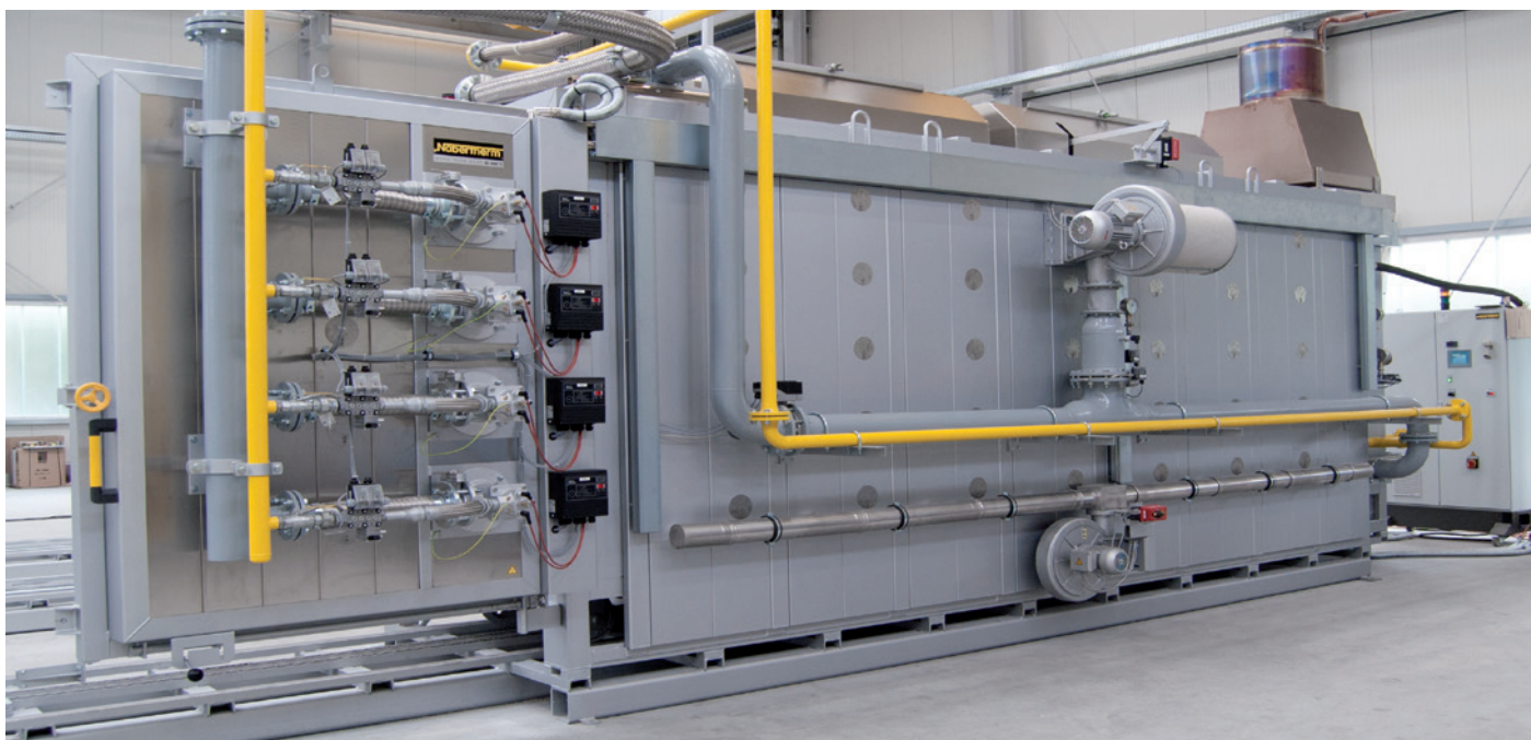
Kammerofen, Werksfoto Nabertherm
