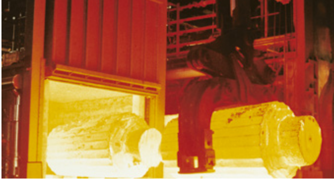
Wagenherd-Schmeldeofen in der Metallindustrie
