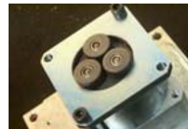
Visão interna de atuador SMARTLINK®, mostrando redutores planetários
