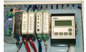
Interface de Controle com os opcionais Display de Usuário, Entrada e Saída de Relé e Interfaces de Rede em um conjunto de painéis pré-programado
