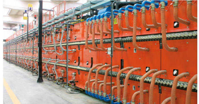
Four à rouleaux dans l'industrie de la céramique
