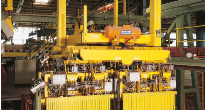
Compensateurs en acier spécial sur four de briqueterie
