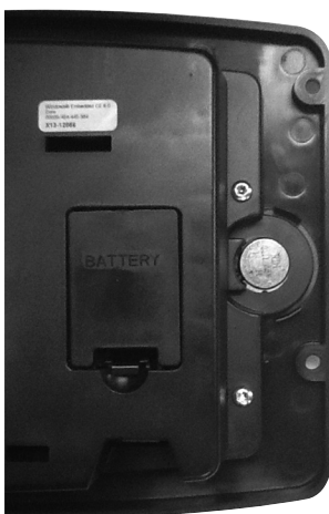
Fig. 5. Compartiment de la pile.
