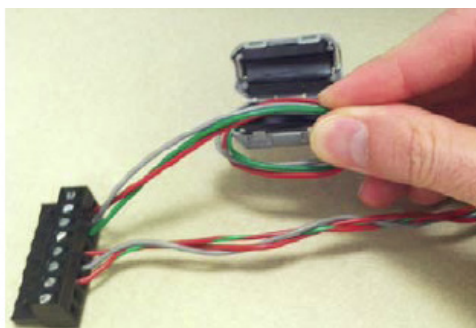
Fig. 3. Installez les filtres à collier sur les connexions 24 V c.a. et Modbus.
