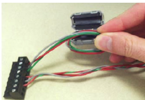
Fig. 3. Instale filtros de ferrita nas conexões 24Vac e Modbus.
