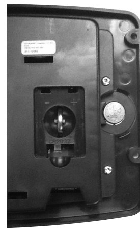
Fig. 6. Instale a bateria botão CR2032
