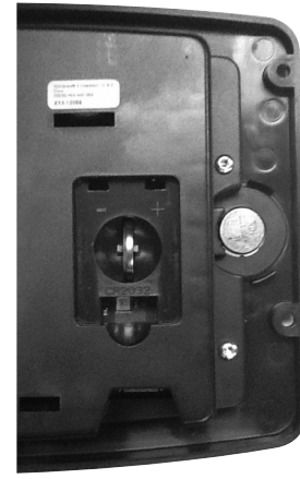
Fig. 6. Colocación de la pila de botón CR2032.
