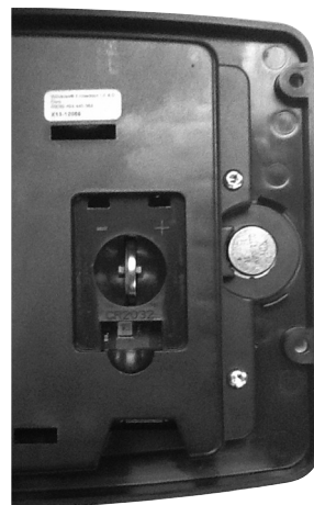
Fig. 6. Installez la pile bouton CR2032.
