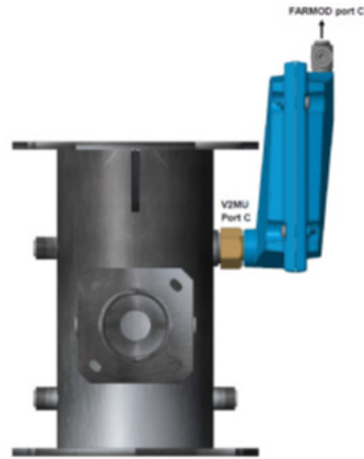
Abb. 4. Montagebeispiel eines Wärmetauschers mit vertikaler Ausrichtung der Mischeinheit (dargestellt mit 300kW Mischeinheit)
