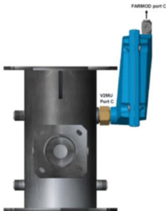
Afb. 4. Voorbeeld van montage van warmtewisselaar met horizontale oriëntatie van de mengeenheid (weergegeven met 300kW mengeenheid).
