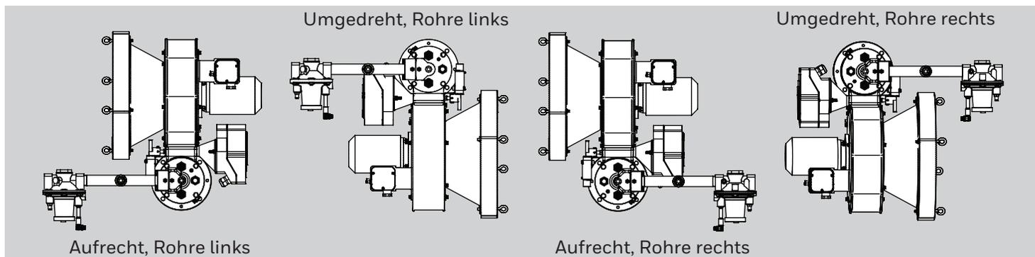
Obwohl sich der Gebläsemotor auf der „linken“ Seite der umgedrehten Einheiten befindet, handelt es sich in Bezug auf die Gebläsebaugruppe weiterhin um einen „rechten“ Motor.
