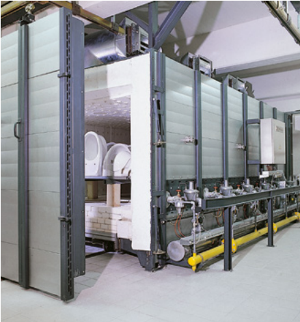
Keramikofen mit Temperaturregelung über Taktsteuerung
