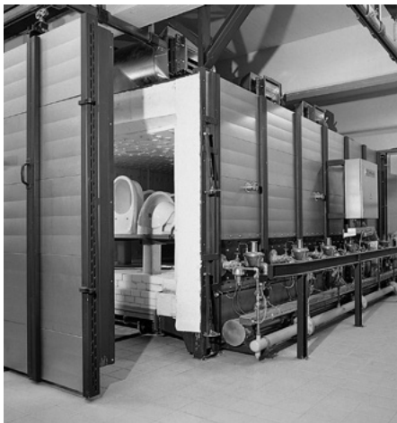
Four à céramique avec régulation de température par séquenceur
