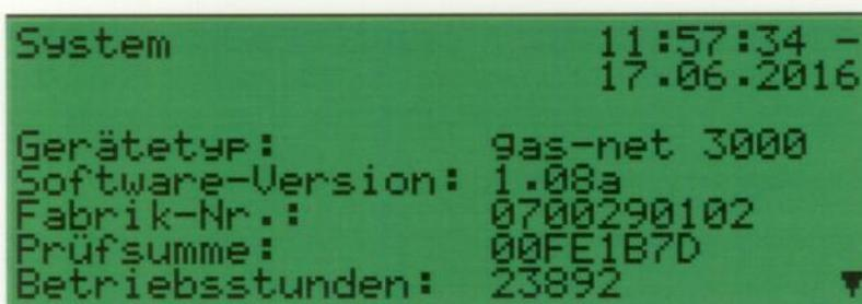
Abbildung 12: Anzeige einer der beiden möglichen Softwareversionen des Prozessrechners
