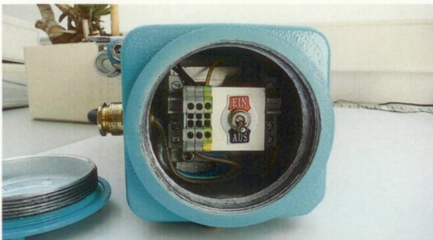
Abbildung 29: externer Eichschalter mit separatem Gehäuse
